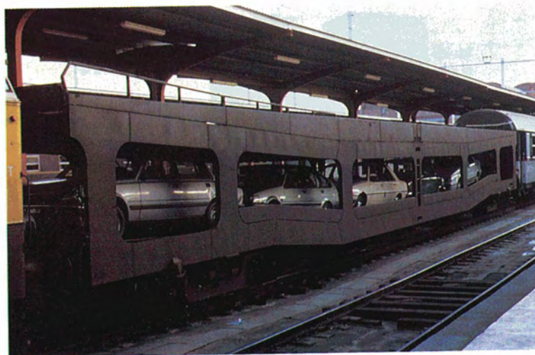
Furgón porta-automóviles de RENFE que está equipado para el cambio de bogies en la frontera francesa. En este caso se trata del DDMA-9.501. Chamartin (23/11/91). Antonio G. Portas.
