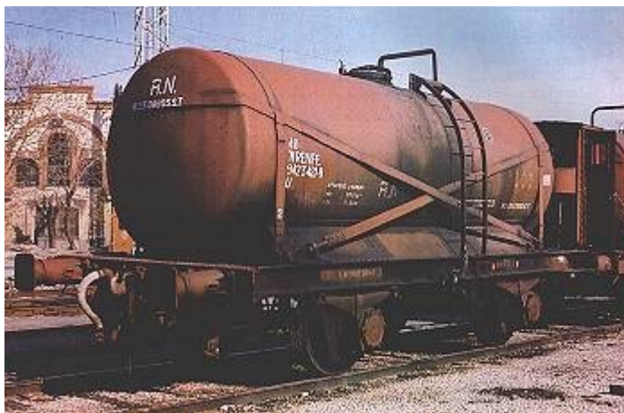
Vagón cuba reutilizado modernamente para transporte de gassóleo.
