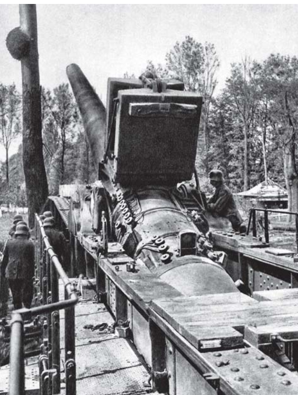
Die geladene Kanone wird in der Höhe ausgerichtet. Vor dem Abschuss wird die Umgebung mit künstlichem Nebel zum Tarnen des Mündungsfeuers vor feindlicher Sicht eingehüllt.
