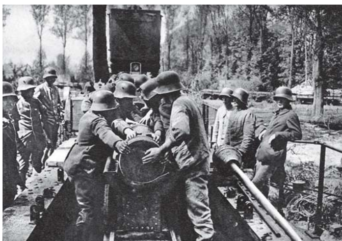
Die Granate wird ins Rohr geschoben. Die Schussweite betrug bis zu 47 Kilometer. In erster Linie wurden strategische Ziele wie Eisenbahnen oder auch wichtige Umschlagplätze angegriffen.
