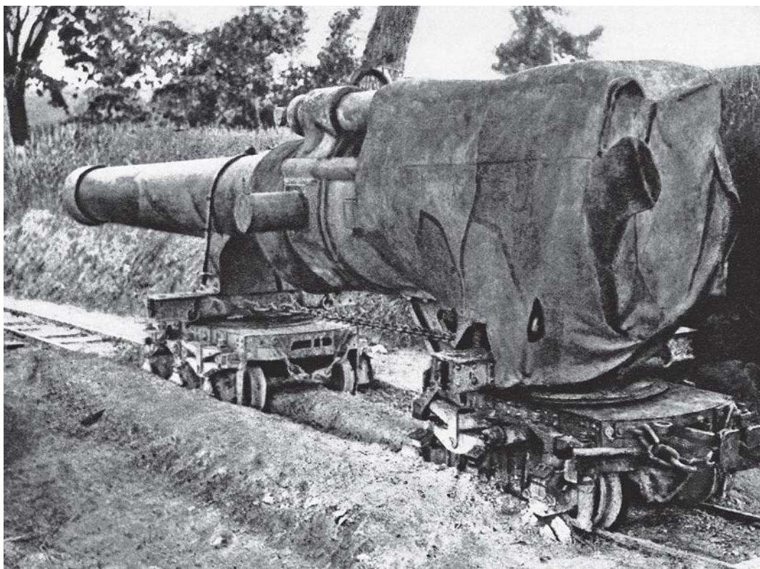
Das 24-Zentimeter-Geschütz ruht auf Drehschemelwagen für den Transport in den Einsatzraum bei Bouvancourt an der Marne im Oktober 1916.
