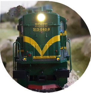
Foco principal, luces posición y luces rojas activadas por diferentes funciones Head lights, position , marker lights and red lights activated by different functions.
