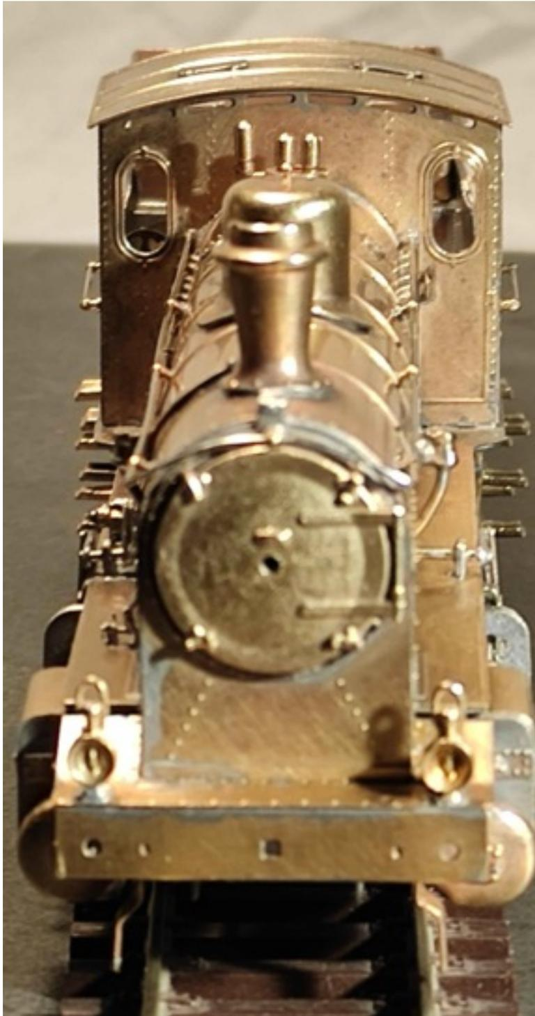
Monte los soportes laterales del pasamanos, con el hilo de 0.45 mm que se sirve, déle forma como se ve en la fotografía adjunta, en el soporte sobrante preestañe el vástago y lo enhebra al hilo de 0.45mm, monte el hilo en los soportes laterales y coloque el pasamanos encima de la puerta de la caldera, déle bien de flux y caliente hasta que se suelde bien al frontal, suelde por el interior de la cabina el pasamanos procurando que la curva del frontal quede paralela al mismo.
