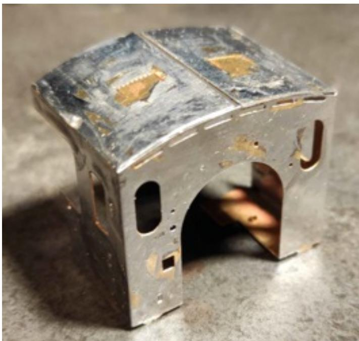
Doble primero las dos alas del techo de la pieza 26. Gire 90° los laterales de la cabina y termine de ajustar el techo. Una con soldadura ambas alas del techo. Suelde las piezas 26bis para asegurar la forma del techo.
