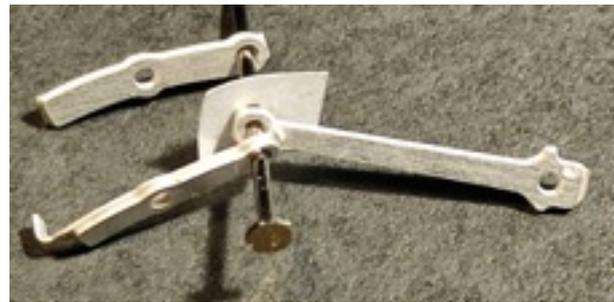
Separe del blíster las piezas 90 y 91. Tenga la precaución de dejar en las piezas que llevan los remaches en la parte superior la lengüeta de sujeción al blíster y doble como se indica. Móntelas como en las fotografías adjuntas, Suelde aplicando flux solo en la parte donde lleva punta el alfiler, corte el sobrante y lime dejando un resalte de estaño de unas 5 décimas de mm. Vea las fotos de la
