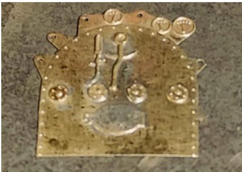
Coja las piezas 33 y 34 y móntelas como en la fotografía, es el momento de soldarle los adornos: registros, nivel de agua, manija de control de la válvula de vapor y puerta de carga de la caja de fuegos. Doble la pieza 32 usando como guía el conjunto 33+34 y la base 31+31bis. Suelde primero la pieza 32 a la base 31+31bis, ahora proceda
