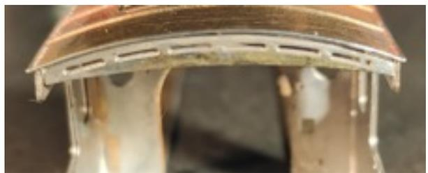
Soldar el montaje al conjunto de piezas 14 y 21. Probar que todo casa bien con el bastidor.
