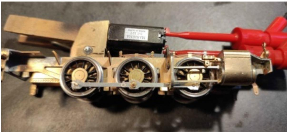
superior. Monte las bielas 83 en el lado contrario y fíjelas con las respectivas arandelas 95, corte el sobrante de los bulones de los ejes 1º y 3º y compruebe que el motor mueve el conjunto de ejes acoplados con finura y poco consumo de corriente, compruebe que no hay picos de consumo, una vez lubricados los
