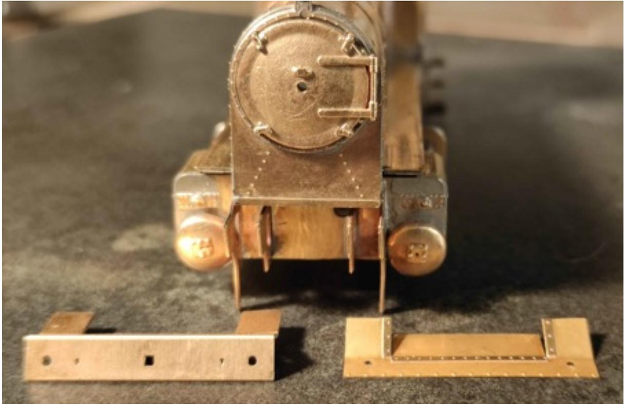
Doblar las piezas 13 y 71 como se ve en la fotografía superior, guíese por los largueros del bastidor, suelde ambas entre sí, colóquelas en el bastidor y
