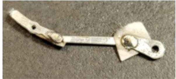
Monte las piezas 93 sobre los conjuntos anteriores teniendo cuidado con la posición, siempre por el lado interno. Corte el alfiler y lime con una radial despacito para que no se desuelde por exceso de calor.
