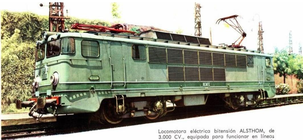
Locomotora eléctrica bitensión ALSTHOM, de 3.000 CV., equipada para funcionar en líneas electrificadas tanto a 1.500 como a 3.000 V., de las cuales ya están en servicio 4 unidades.
