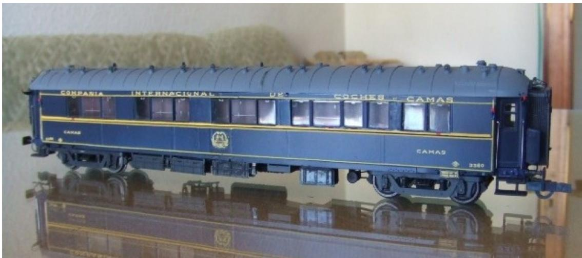
Como ya se comentó en su momento, se ha obtenido por modificación profunda de un coche LsModels tipo SG ( derivado del S1 ), con corte de secciones de caja, techo y chasis para reducir su longitud en los casi 2 metros reales que es necesario encoger.
