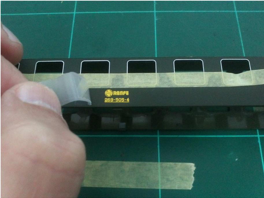
Después de despegar el celofán, y la cinta que nos ha servido de guía, con el papel del propio transfer, presionamos encima, para asegurarnos que ha pegado bien. Insisto mucho con la alineación, si os fijáis en la foto, he procurado dejarlo algo torcido...
