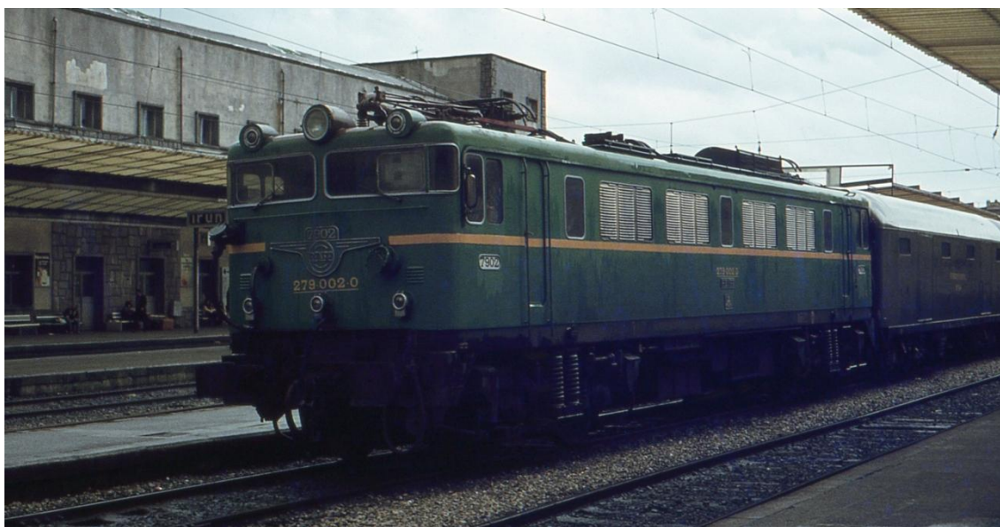
Foto de la 7902 real en Irún 1978 aún sin dualizar; sin calderines en el techo, sin mangueras normalizadas de aire, y con la manguera de aire del múltiple visible debajo mismo del piloto central en la parte baja.
