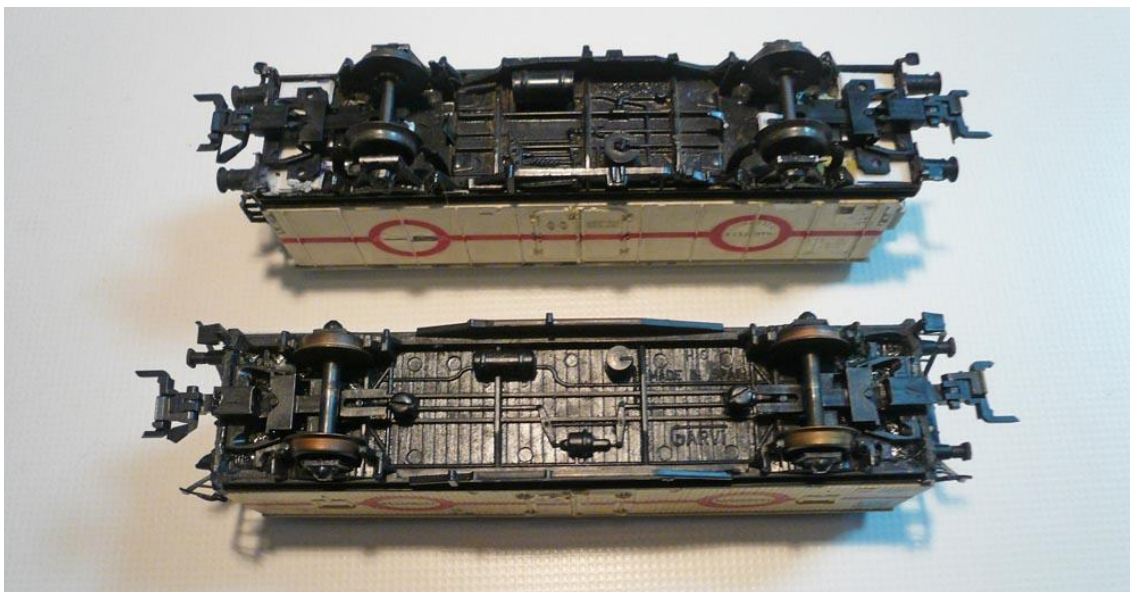
Foto nº 7 - Colocación de las cinemáticas Roco.
