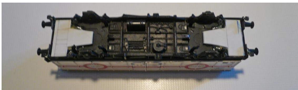
Foto nº 6 - Base para asentar las cinemáticas en vagones Electrotren.
