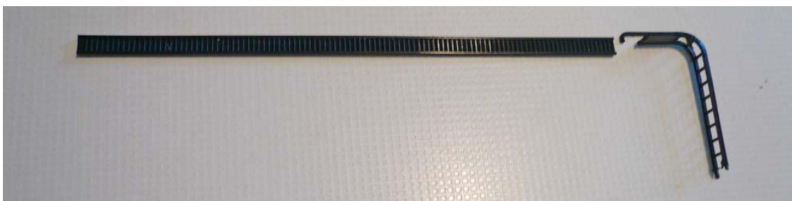
Foto nº 36 - Construcción de la pasarela: una brida y la escalerilla.
