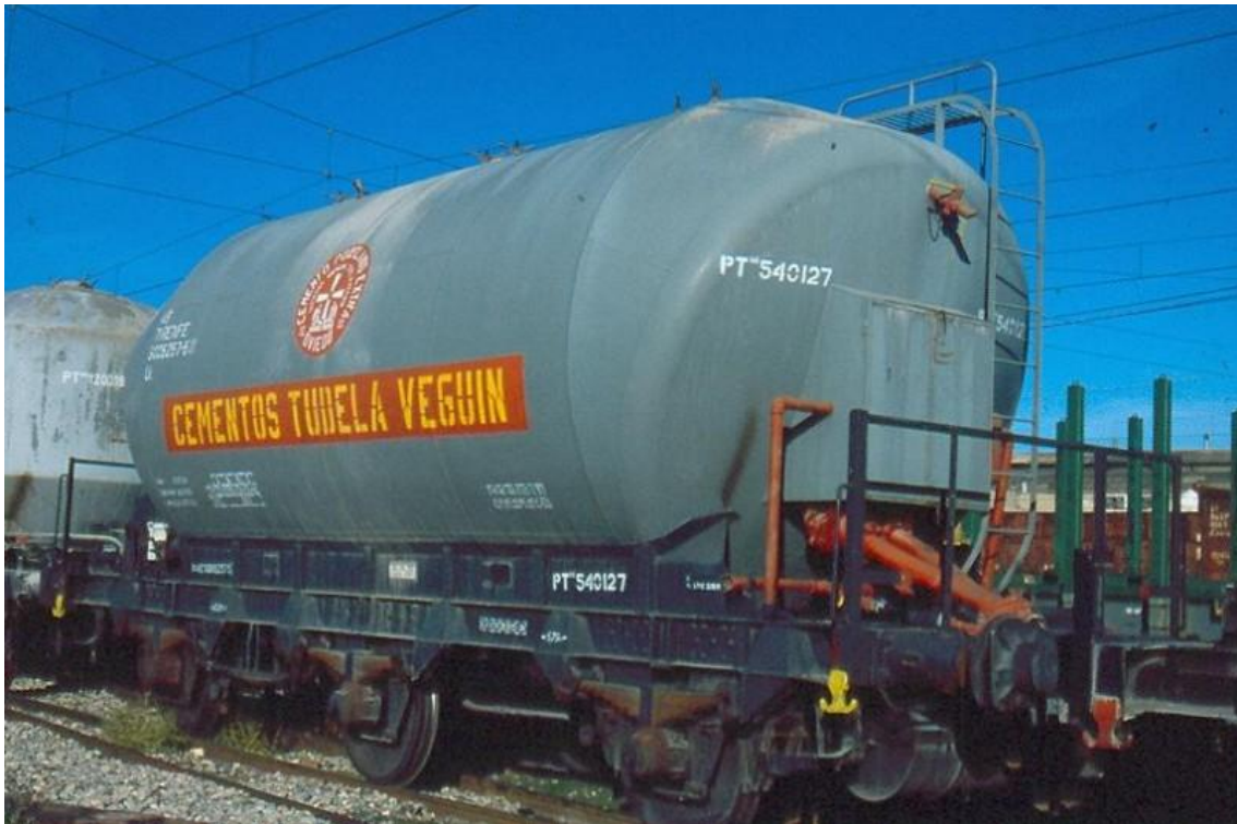
Foto nº 42 - Tolva con chasis corto y 3 ejes. ( Foto autor desconocido ).
