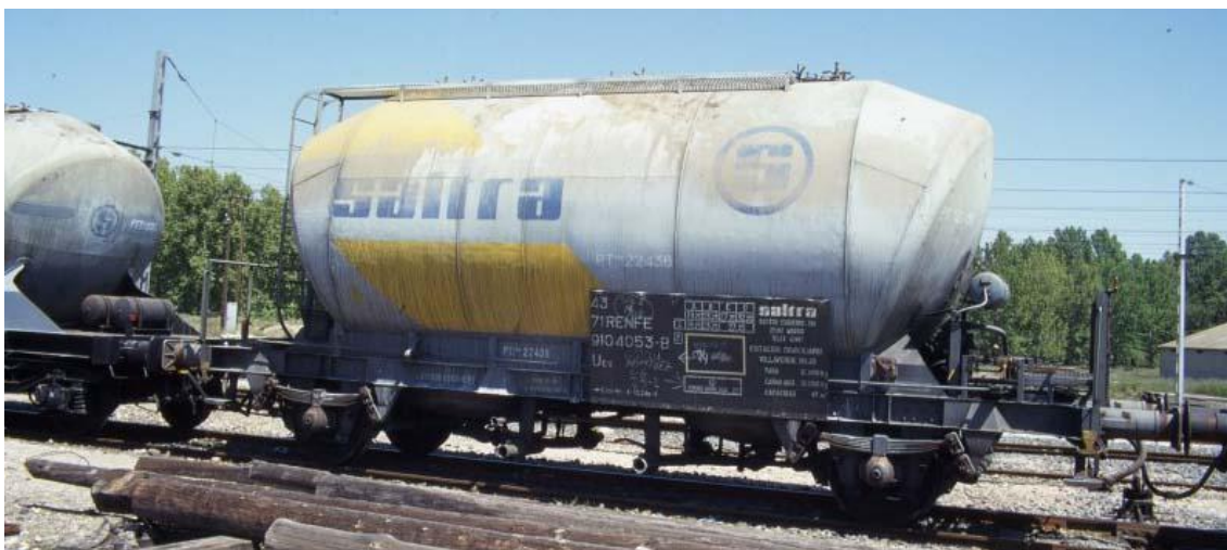
Foto nº 30 - Tolva de chasis corto y 2 ejes. ( Foto autor desconocido ).
