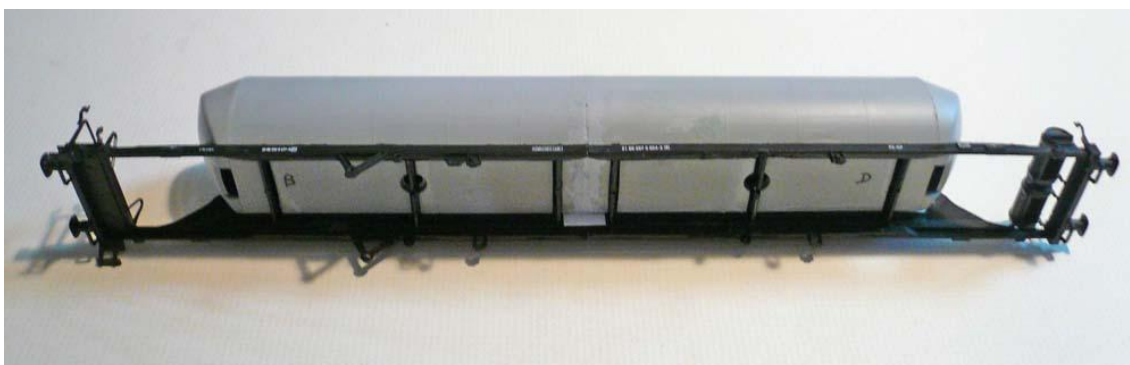
Foto nº 10 - Unión del contorno del chasis ( piezas G ) a la cisterna.
