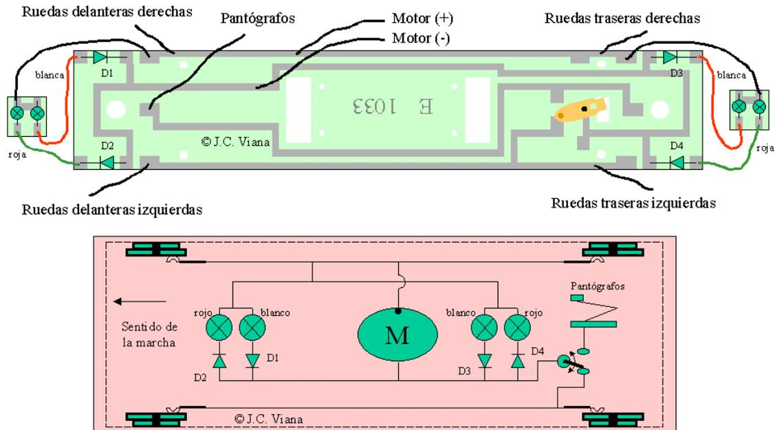
Como se aprecia en la figura, sobre el mismo circuito impreso central, además de la mayoría de las conexiones, se sitúan los elementos que permiten elegir, mediante un rudimentario conmutador accesible desde el exterior sin desmontar la tapa del modelo, la utilización o no de los pantógrafos. En el caso de utilizar alimentación por catenaria, la conexión a los pantógrafos sustituye a la conexión a las ruedas izquierdas.
