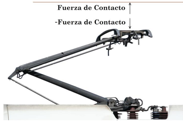
Figura 11.2: Fuerza de contacto en cada sistema independiente. Acción y reacción.
