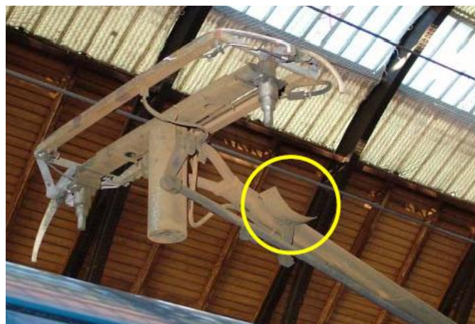
Imagen 7.6: Detalle del deflector aerodinámico [41].
