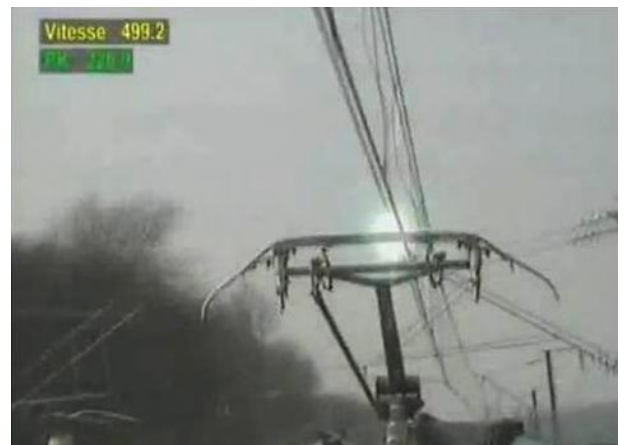
Imágenes 7.19 y 7.20: Arco eléctrico, tren TGV de Alstom. Imagen captada desde avión (izquierda) y desde el techo del vehículo (derecha) [45]. Velocidad 574,8 km/h.
