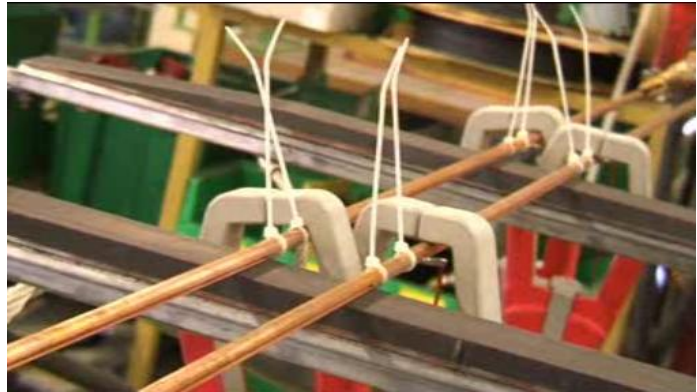
Figura 6.13: Pruebas de contacto entre hilo de contacto y frotadores [39].
