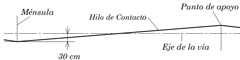
Figura 5.26: Esquema en planta del hilo de contacto en zigzag.
