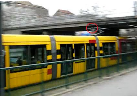
Imagen 7.16: Arco eléctrico en un tranvía producido por el ascenso del pantógrafo tras pasar bajo un puente en el que la altura del hilo de contacto ha descendido [4].
