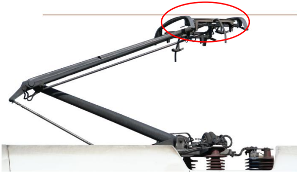
Figura 11.1: Punto de contacto entre la mesilla y el hilo de contacto.
