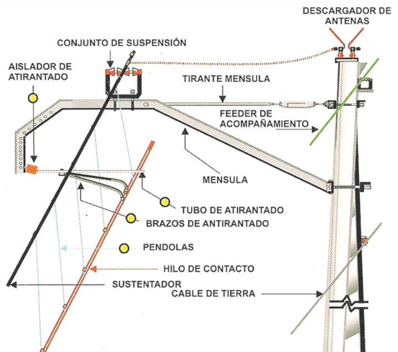
Figura 5.2: Elementos de la catenaria CR160 de RENFE [9].
