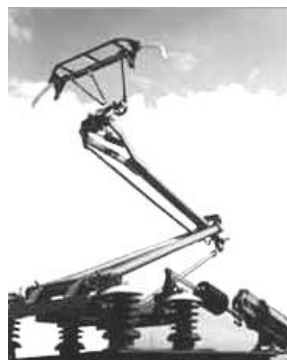
Imagen 6.11: Pantógrafo modelo AMDE en el TGV-PSE [38].
