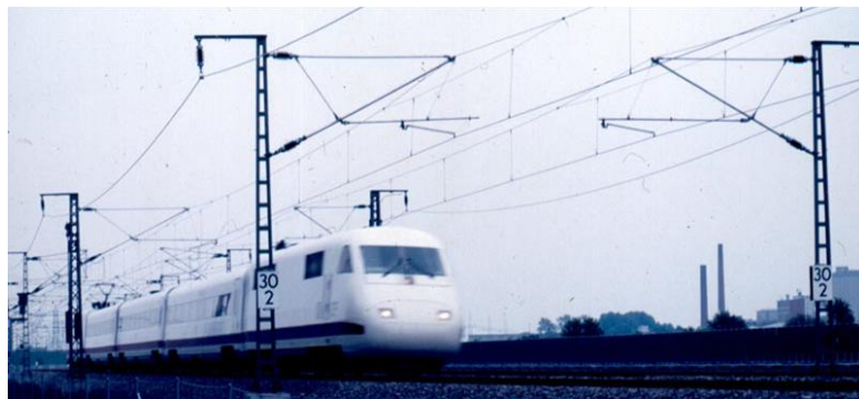
Imagen 7.23: Tren ICE – V durante la obtención del récord de alta velocidad (400 km/h) bajo catenaria Re250 con péndola en Y [4].
