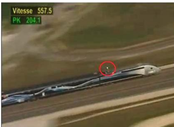
Imágenes 7.19 y 7.20: Arco eléctrico, tren TGV de Alstom. Imagen captada desde avión (izquierda) y desde el techo del vehículo (derecha) [45]. Velocidad 574,8 km/h.
