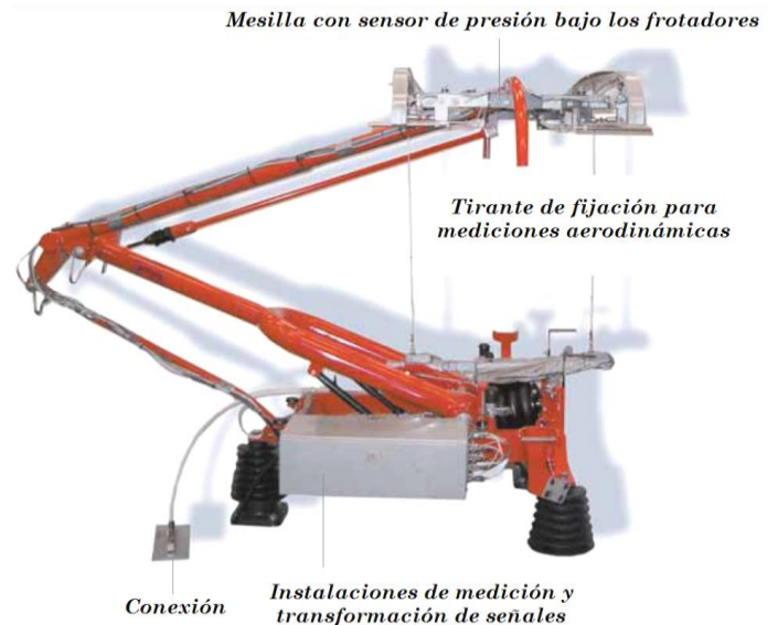
Imagen 7.9: Sistema de medición de esfuerzos aerodinámicos sobre pantógrafo Schunk [42].
