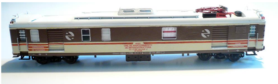
Foto nº 18 - Coche engrasador de catenaria terminado. LADO 1.
