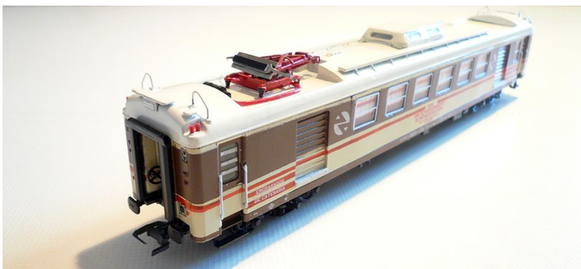
Foto nº 20 - Coche engrasador de catenaria terminado. Vista en perspectiva.
