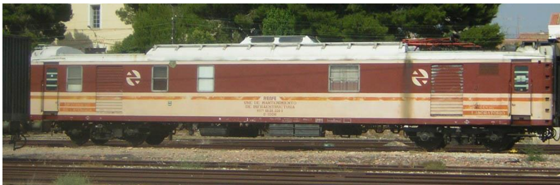
Foto nº 1 - Coche laboratorio engrasador de catenaria. (Foto autor desconocido).
