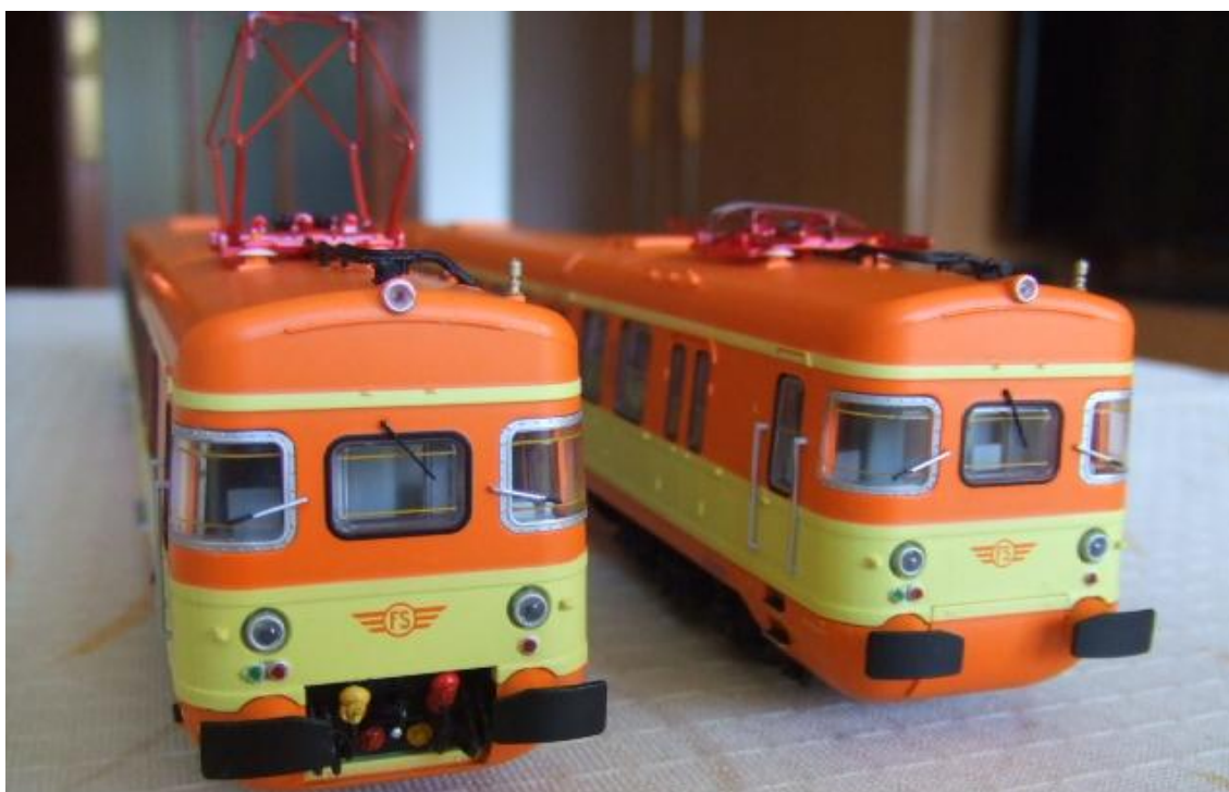
Alternativa en la disposición de los testeros extremos, conforme a la realidad : a la izquierda, con la trampilla abierta para acople de otra unidad, con sus 4 mangueras de aire y sus 2 gruesos conectores para mando múltiple; a la derecha, la opción de trampilla cerrada con la inserción de una pieza de carenaje suministrada como accesorio amovible. Bien pensado.
