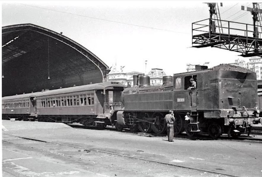
La 232-0210 en cabeza de un tren de cercanías en la estación de Madrid-Atocha en marzo de 1955. Si se compara con la imagen anterior se observa el cajón añadido a la carbonera que afectaba a su estética y empeoraba la visibilidad para la pareja de conducción (Foto: Wyrsh/Archivo Histórico Ferroviario del Museo del Ferrocarril de Madrid (AHF/MFM))
