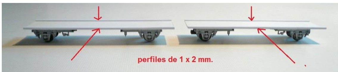
Foto nº 6 - Colocación de los bordes laterales.
