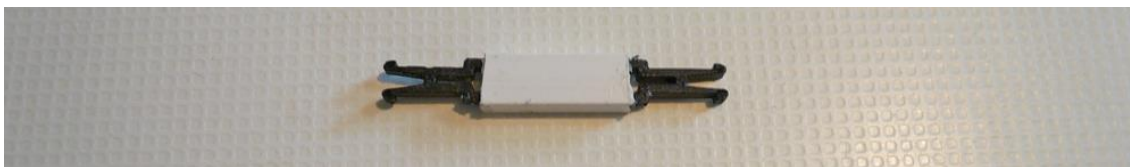
Foto nº 9 - Enganche para la unión de las dos semi plataformas.
