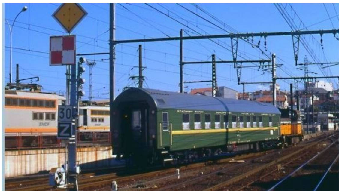
Un tractor Y-8000 de la SNCF maniobra el coche cama SZD hacia las instalaciones de cambio de ancho de Hendaya. Fechada en marzo-1990, se trata sin duda de una prueba previa a la implantación comercial. Foto J.C. Perraud.
