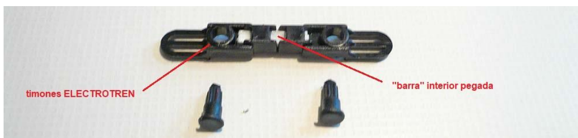
Foto nº 12 - Barra-enganche entre semi chasis.
