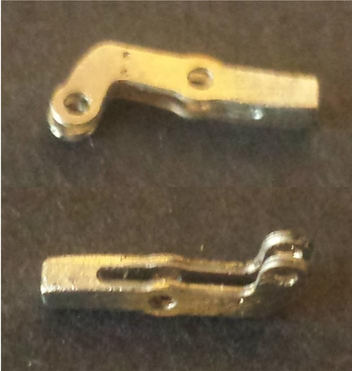
Preparar las piezas B05 y B06 y el sector, montarlas como se indica en las fotografías, cuidar la posición de las bielas. Soldar y limpiar como en ocasiones anteriores.
