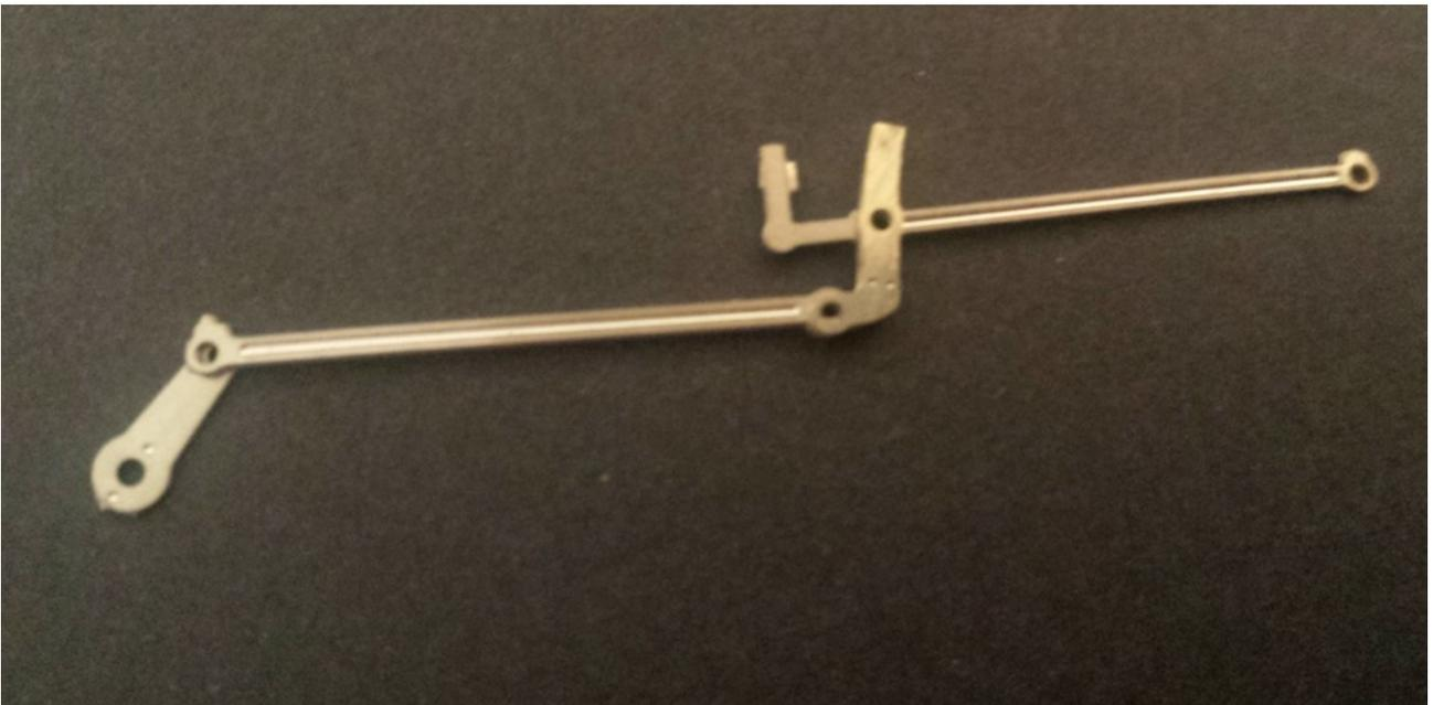
Montar el conjunto con la biela B17. ¡OJO! esta biela está sesgada para acoplarla con facilidad, he observado que si la pieza de fundición que la soporta no está bien montada queda muy justa, para evitar esto calentar la pieza soporte en la soldadura hasta que fluya para ajustarla mejor con la base y si fuese necesario repasar ligeramente la biela B17 con una lima de pelo. Esto se debe a que las piezas de fundición a la cera perdida tienen unos márgenes de tolerancia muy elevados.
